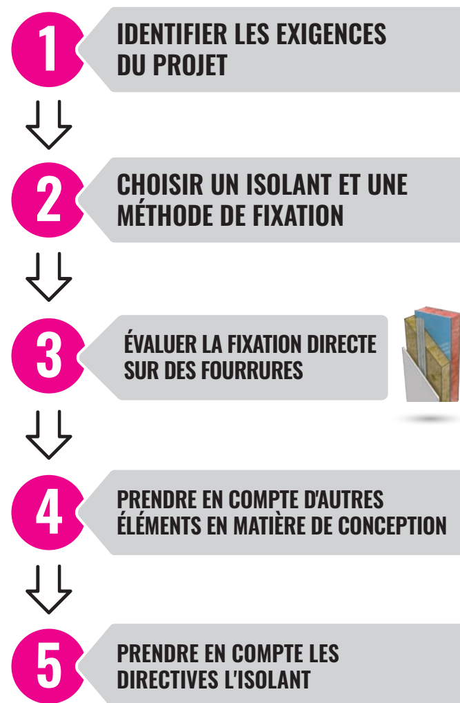
Figure 2. Étapes de la conception de l'isolant continu
